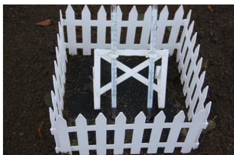
2 termometry glebowe wraz ze statywem plus płótkiem odgradzającym
